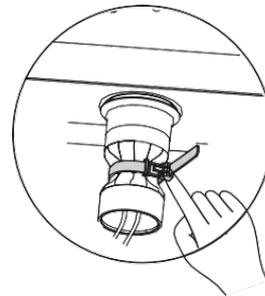
2. Después de la instalación o el mantenimiento, el cinturón de apriete debe estar apretado, no se puede aflojar ni desechar; Se debe instalar el panel de acceso a la caja de control y apretar los tornillos.
